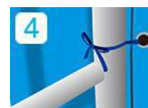
4 メッシュと単管の間で ひもをクロスしてから、 単管に結束する
